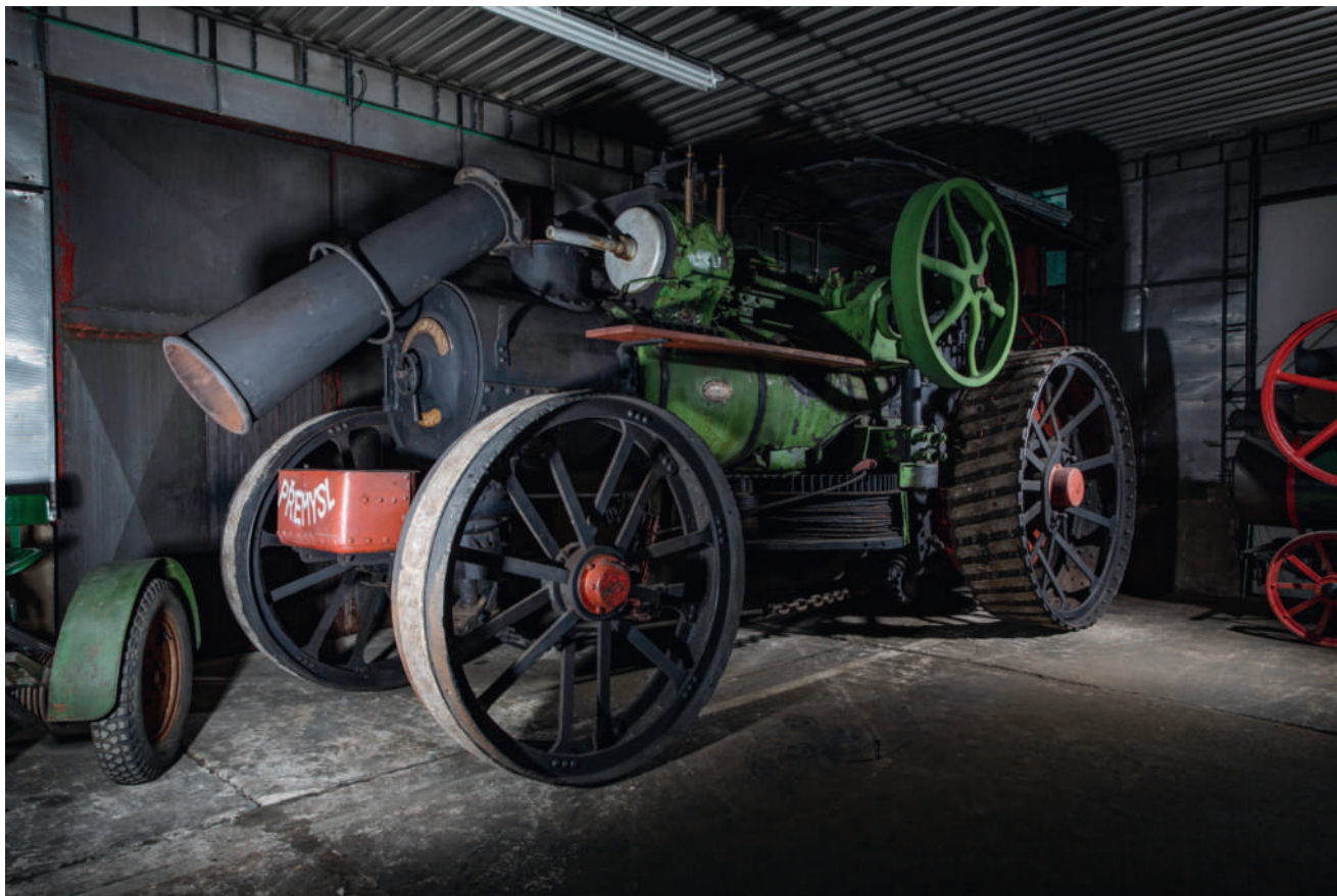
19 | Přemysl – parní oračka Fowler, rok výroby 1906. Délka 7,5 m / výška 4,3 m / šířka 2,47 m / rozvor 4,52 m / průměr předního kola 1,64 m / průměr zadního kola 2,14 m
